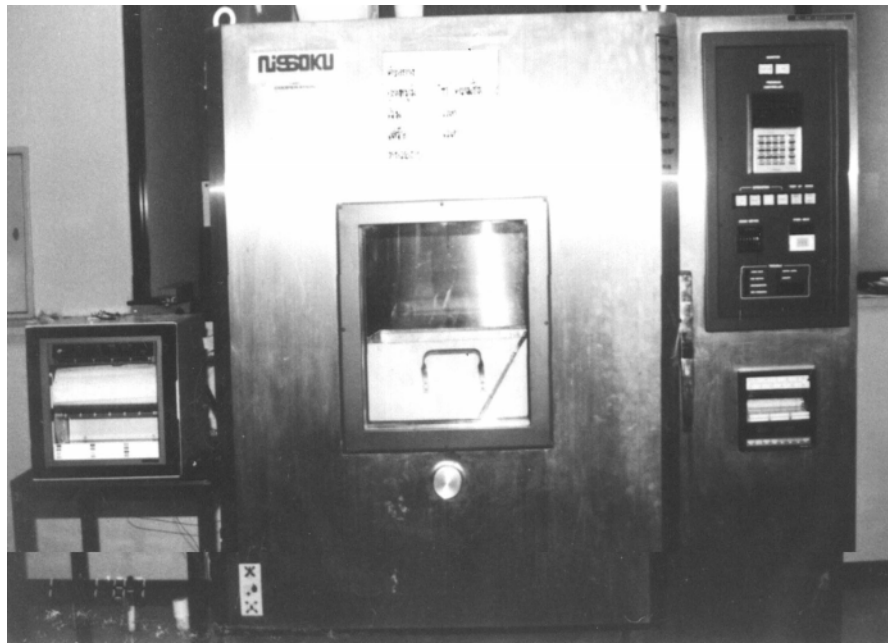
รูปที่ 4 การวัดการแผ่กระจายความร้อนโดยวิธี Periodic Stationary Method
