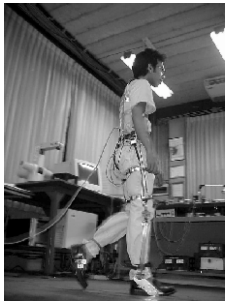
รูปที่ 5 เครื่องมือวัดการเคลื่อนที่ของข้อต่อมนุษย์
