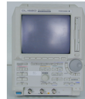
รูปที่ 30 ออสซิลโลสโคป Yokogawa
