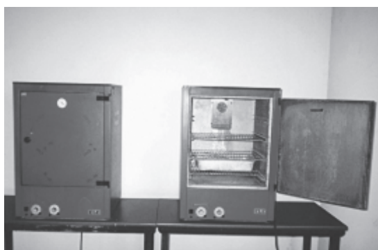
รูปที่ 3 ตู้สำหรับใช้บ่มตัวอย่างที่อุณหภูมิ 50 \pm 2 และ 75 \pm 2 องศาเซลเซียส
