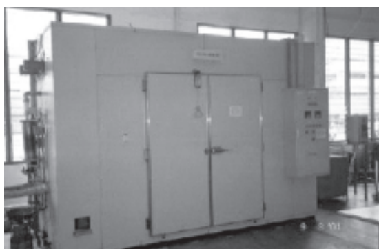
รูปที่ 2 ตู้สำหรับใช้บ่มตัวอย่างที่อุณหภูมิ 25 องศาเซลเซียส
