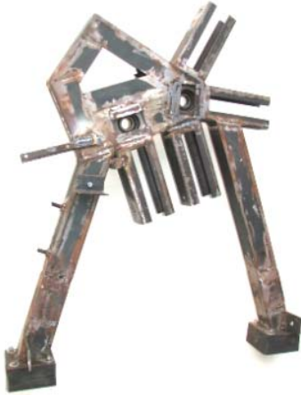
รูปที่ 2 เชื่อมเหล็กแผ่นเป็นโครงสร้างด้านซ้าย
