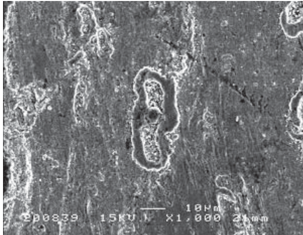
รูปที่ 6 เศษจากการสึกหรอที่มีลักษณะกลมและร่องจากการสึกหรอบนผิวหน้าของเหล็กกล้าไร้สนิม หลังทดสอบการสึกหรอแบบเฟรดตั้งที่อุณหภูมิ 500 °ซ เป็นเวลา 96 ชม.
