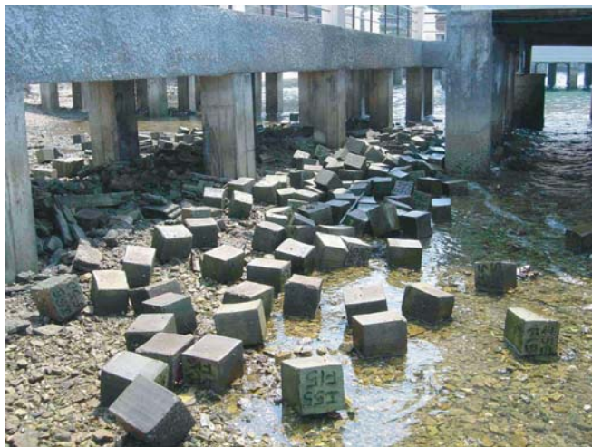
รูปที่ 1 ตัวอย่างคอนกรีตที่แช่ในน้ำทะเลในสภาพเปียกสลบแห้ง
