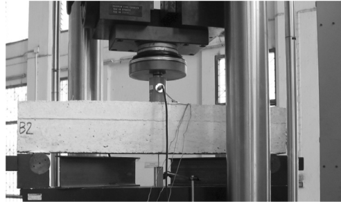
รูปที่ 9 การทดสอบกำลังรับแรงดัดของคานคอนกรีตเสริมเหล็กที่ผสมเส้นใย
