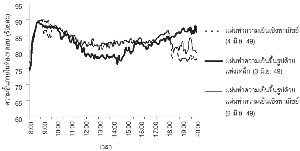
รูปที่ 13 กราฟแสดงความชื้นสัมพัทธ์ภายในห้องทดสอบที่ทดสอบเป็นเวลา 12 ชั่วโมง
