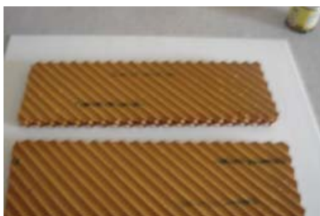
รูปที่ 6 แผ่นทำความเย็นเชิงพาณิชย์ที่ใช้ในการขึ้นรูป
