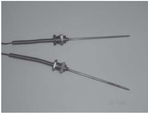
ลักษณะของหัววัด ( \varnothing 3 มม. ยาว 120 มม.)
