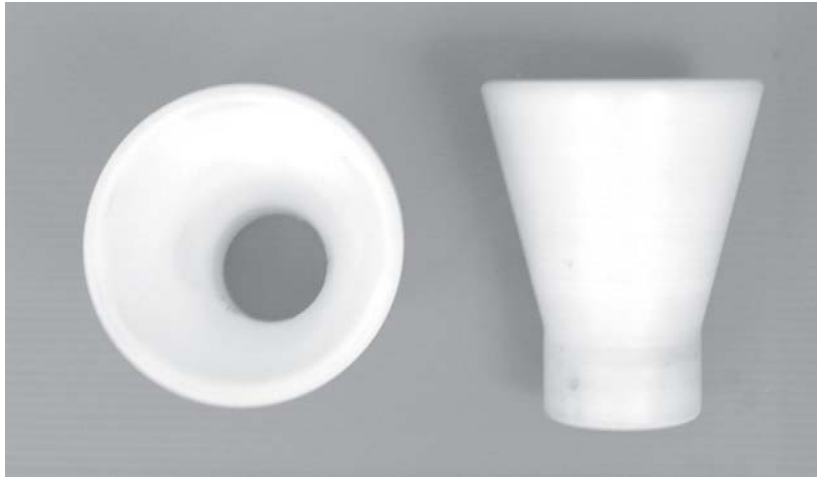
รูปที่ 14 stress cone สำหรับตรวจวัด PD ในสายเคเบิลพิกัด 12/20(24) kV 240 มม. 2
