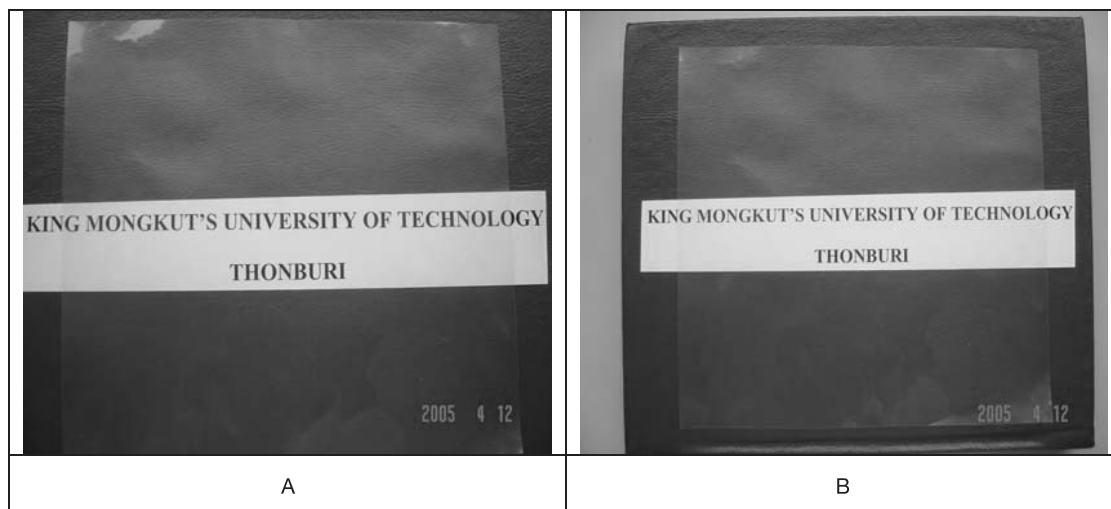
รูปที่ 2 ลักษณะปรากฏของฟิล์มที่เตรียมจากเจลแบ่งที่ผ่านการให้ความร้อน 80°C นาน 20 นาที (A) และที่ผ่านการให้ความร้อนที่ 121°C ภายใต้ความดัน นาน 20 นาที (B)
