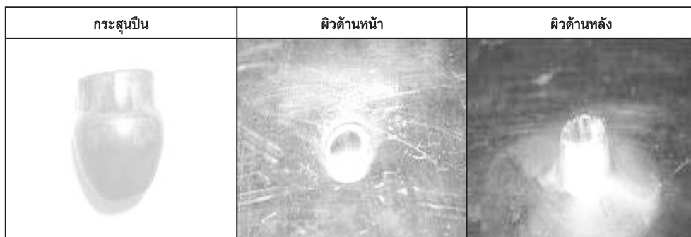
รูปที่ 11 ลักษณะการเปลี่ยนรูปของกระสุนปืนและแผ่นอะลูมิเนียมเกรด AA1100 ที่ความหนา 4 มม.
