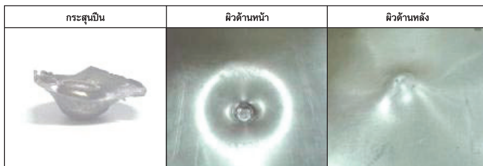
รูปที่ 13 ลักษณะการเปลี่ยนรูปของกระสุนปืนและแผ่นอะลูมิเนียมเกรด AA5083 ที่ความหนา 4 มม.
