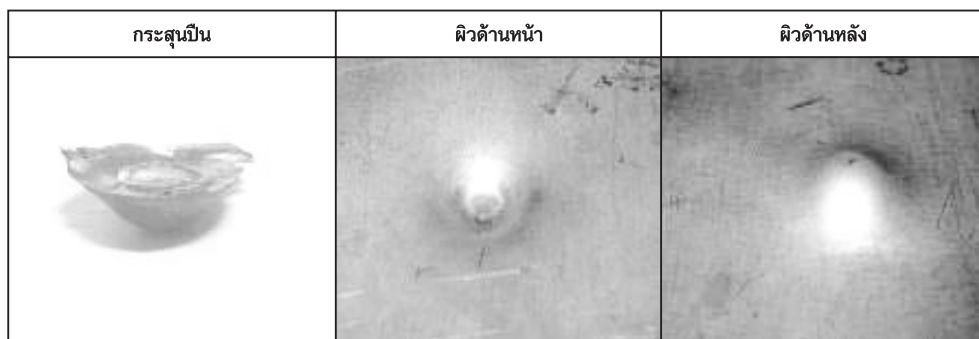
รูปที่ 7 ลักษณะการเปลี่ยนรูปของกระสุนปืนและแผ่นเหล็กกล้าเกรด AISI1008 ที่ความหนา 2 มม.
