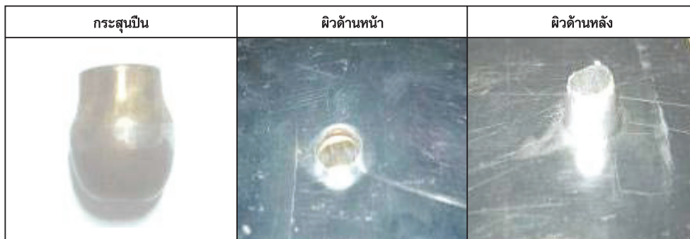
รูปที่ 12 ลักษณะการเปลี่ยนรูปของกระสุนปืนและแผ่นอะลูมิเนียมเกรด AA1100 ที่ความหนา 6 มม.
