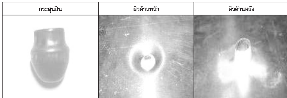
รูปที่ 10 ลักษณะการเปลี่ยนรูปของกระสุนปืนและแผ่นอะลูมิเนียมเกรด AA1100 ที่ความหนา 2 มม.
