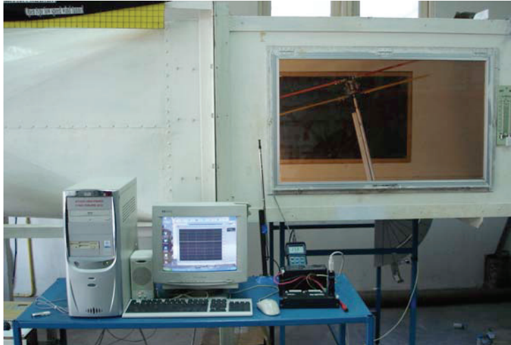
รูปที่ 9 ภาพถ่ายการทดสอบโรเตอร์แบบใช้เพลาร่วมแกนสองโรเตอร์ส่งกำลังหมุนสวนทาง
