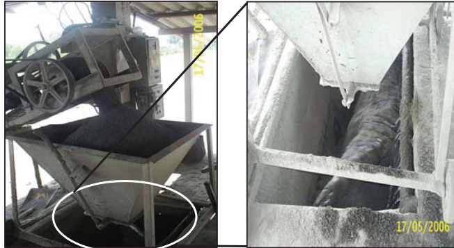
รูปที่ 3 การลำเลียงวัสดุมวลรวมลงผสมในเครื่องกวน
