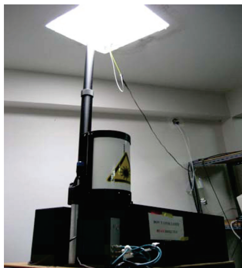
Fig. 1 Mie scattering LIDAR.
