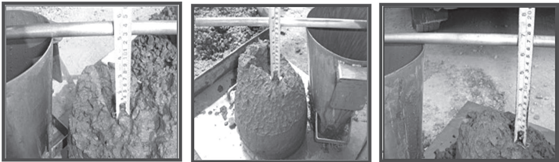
รูปที่ 19 การทดสอบค่าการยุบตัว ของคอนกรีตที่หน้างานจริง (เค.ซี. คอนกรีต, เล็งชนากรณ์ และนายกคอนกรีต) โดยใช้น้ำยาผสมคอนกรีต 10% PC ที่ปริมาณร้อยละ 1.5
