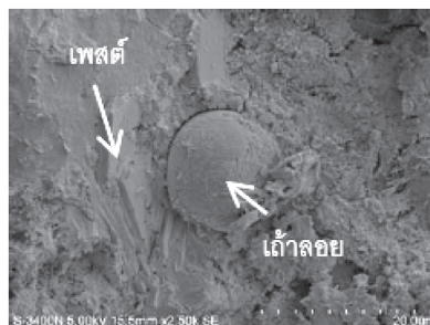
(ค) แสดงส่วนเถ้าลอย ที่กำลังขยาย 2,500 เท่า
