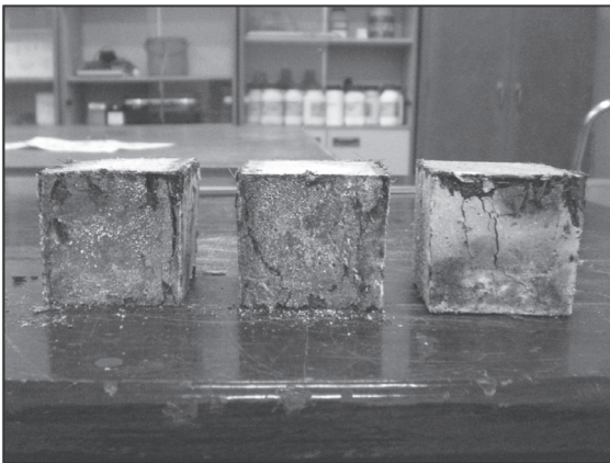
รูปที่ 3 ตัวอย่างภายหลังการทดสอบการสูญเสียกำลังอัดเมื่อแช่ในสารละลายแมกนีเซียมซัลเฟต
