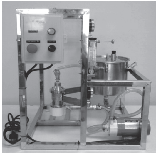
รูปที่ 3 ต้นแบบระบบฆ่าเชื้อจุลินทรีย์ในน้ำนมฯ พัลส์ที่พัฒนาขึ้น
