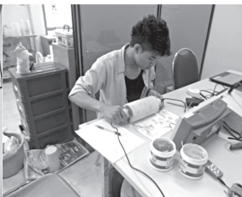
ข) ยิงคลื่นอัลตราโซนิกในคอนกรีต
