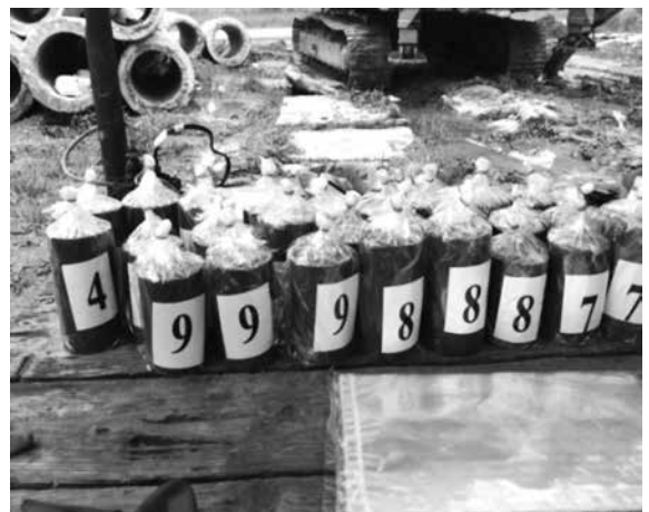
รูปที่ 8 การห่อเก็บตัวอย่างดินซีเมนต์เตรียมไปทดสอบในห้องปฏิบัติการ
