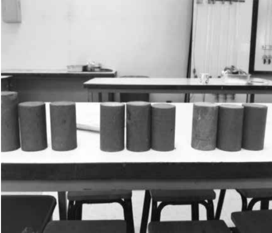
รูปที่ 11 ตัวอย่างดินซีเมนต์พร้อมทดสอบในห้องปฏิบัติการ
