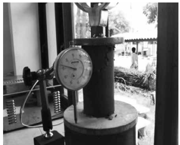
รูปที่ 10 การทดสอบหาค่ากำลังอัดแกนเดียว
