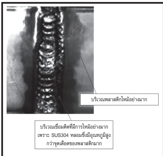
รูปที่ 6 ลักษณะของชิ้นงานเชื่อมเหล็กกล้าไร้สนิมกับพอลิเอทิลีนเทอพาทาเลทกรณีที่วางพอลิเอทิลีนเทอพาทาเลทอยู่ด้านบนของการจับวางชิ้นงานแบบซ้อนเกย ณ กำลังขยายสูงขึ้นมองจากด้านของพอลิเอทิลีนเทอพาทาเลท โดยใช้ความเร็วในการเชื่อม 8 mm/s ระยะโฟกัส 6 mm
