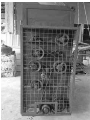
รูปที่ 7 ตะแกรงป้องกันชุดลูกรอก
