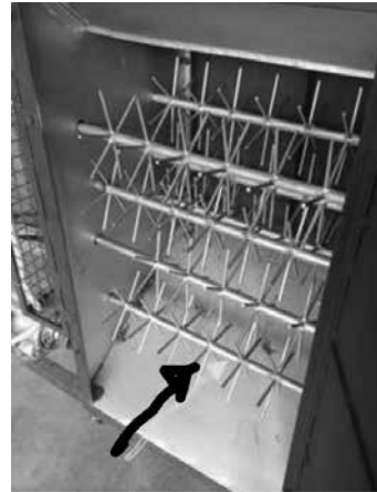
รูปที่ 9 เพลลาที่เสริมเพื่อช่วยการขับยาเส้นออกมา
