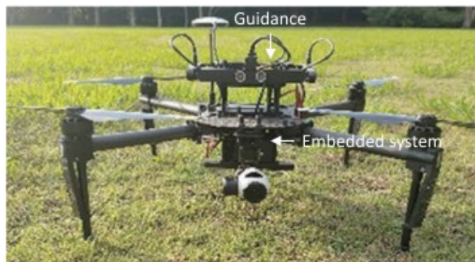
รูปที่ 1 แสดงอากาศยานไร้คนขับ (Quadrotor UAV) [10]
