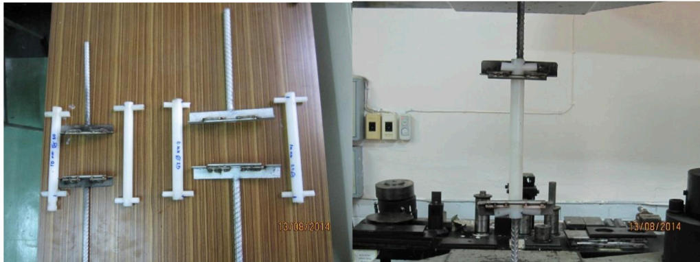
รูปที่ 6 การทดสอบแรงดึงของสลัก Superlean Nylon
