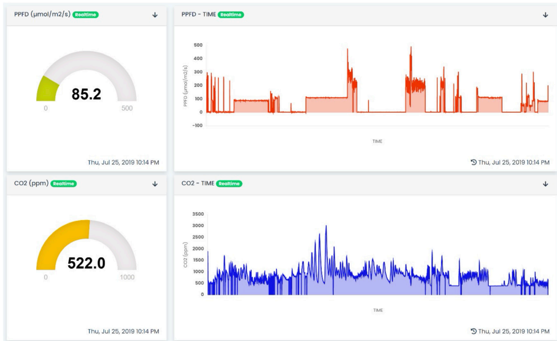
รูปที่ 20 หน้าเว็บแสดงผลค่าความเข้มของแสงและค่าความเข้มข้นของ \text{CO}_2 ภายในตู้เพาะปลูกพืช
