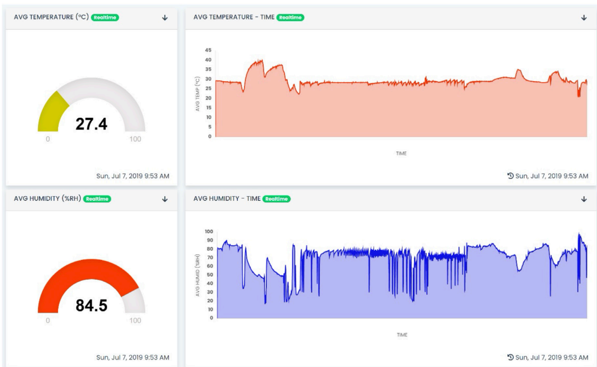
รูปที่ 19 หน้าเว็บแสดงผลค่าเฉลี่ยของอุณหภูมิและความชื้นภายในตู้เพาะปลูกพืช
