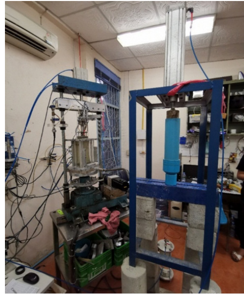
รูปที่ 13 การฉีดดินเหลว
