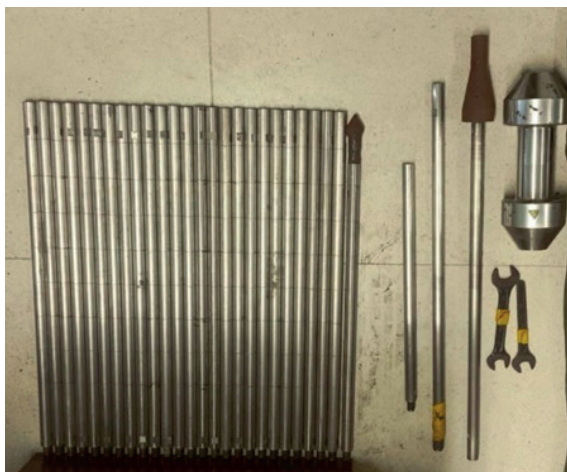
รูปที่ 2 เครื่องเจาะรูปกรวยชนิดกระแทกที่ใช้ในการวัดความลึกดิน
