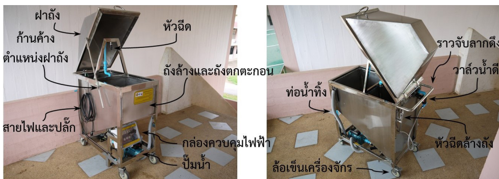
รูปที่ 5 ลักษณะและส่วนประกอบของเครื่องล้างทำความสะอาดสาหร่าย:
