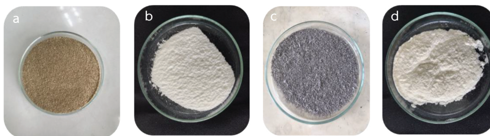
Figure 2 Images of (a) CP, (b) MCC', (c) \text{CP}_{\text{biogas}} and (d) \text{MCC}_{\text{biogas}}
