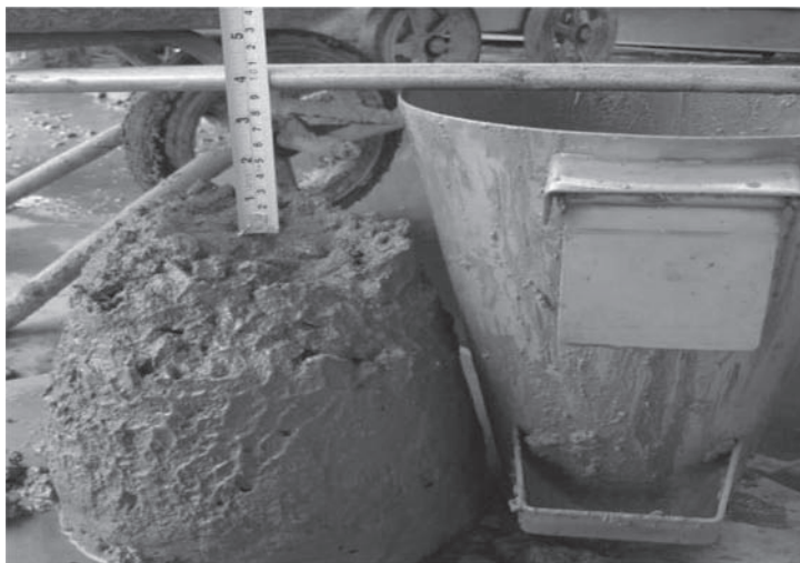
รูปที่ 10 การยุบตัวของคอนกรีตที่ใช้ปูนซีเมนต์ปอร์ตแลนด์ไลม์สโตนในส่วนผสม
