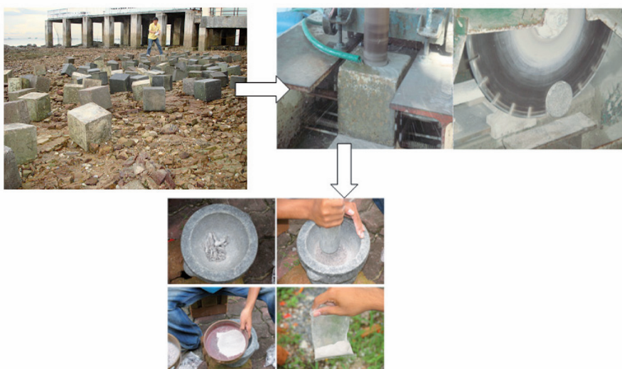
รูปที่ 1 การเตรียมตัวอย่างเพื่อทดสอบปริมาณคลอไรด์ในคอนกรีต
