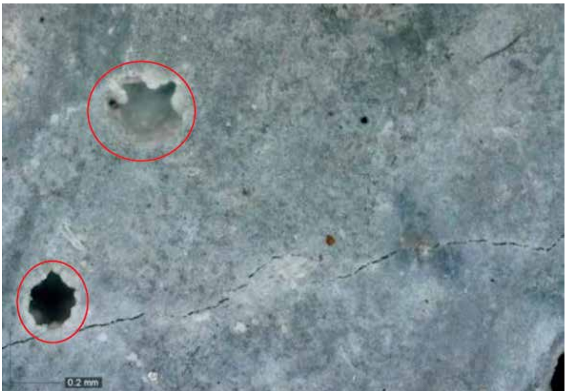
รูปที่ 3 ภาพถ่ายขยายลักษณะผิวของมอร์ตาร์ควบคุม (CT) หลังแช่ในสารละลายโซเดียมไฮดรอกไซด์ที่อุณหภูมิ 80 องศาเซลเซียส เป็นเวลา 28 วัน มีรอยแตกร้าวขนาดเล็ก และมีโซเดียมไฮดรอกไซด์เกาะอยู่บริเวณรูพรุน
