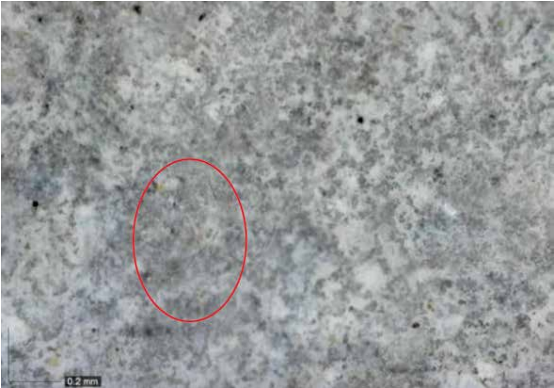
รูปที่ 6 ภาพถ่ายขยายลักษณะผิวของมอร์ตาร์ที่ผสมเถ้าปาล์มน้ำมัน (5POFA40) หลังแช่ในสารละลายโซเดียมไฮดรอกไซด์ 28 วัน ที่อุณหภูมิ 80 องศาเซลเซียส เป็นเวลา 28 วัน มีรอยแตกร้าวขนาดเล็กมาก
