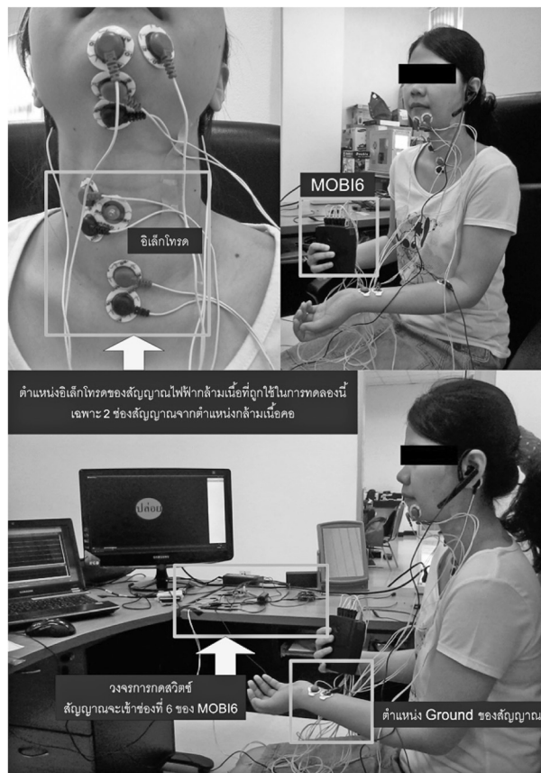
รูปที่ 3 ภาพจริงขณะทำการทดลองเก็บข้อมูลสัญญาณไฟฟ้ากล้ามเนื้อของอาสาสมัคร ซึ่งบทความนี้จะใช้สัญญาณไฟฟ้ากล้ามเนื้อจากตำแหน่งกล้ามเนื้อคอ 2 ตำแหน่งเท่านั้น สำหรับสัญญาณจากตำแหน่งอื่นๆ จะไม่ถูกใช้ในบทความนี้
