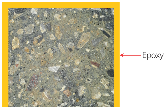
รูปที่ 4 การเตรียมตัวอย่างคอนกรีตเพื่อทดสอบค่าระยะแทรกซึมคลอไรด์
