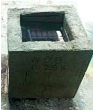
รูปที่ 6 แบบจำลองบ่อทดสอบการรั่วซึมของน้ำ
