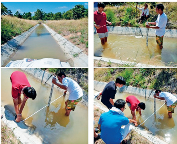
รูปที่ 16 วัดหน้าตัดและความลึกของน้ำในคลองสำหรับใช้คำนวณการรั่วซึม
