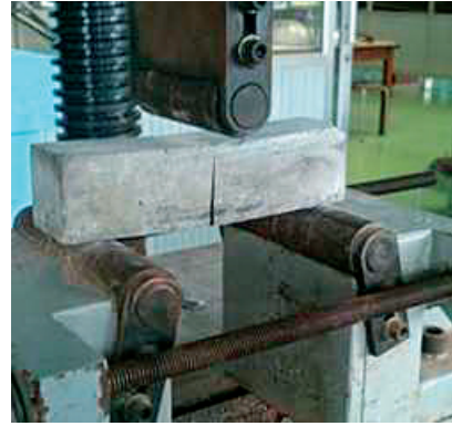
รูปที่ 4 การทดสอบกำลังรับแรงดัดมอร์ตาร์ผสมน้ำยางพารา
