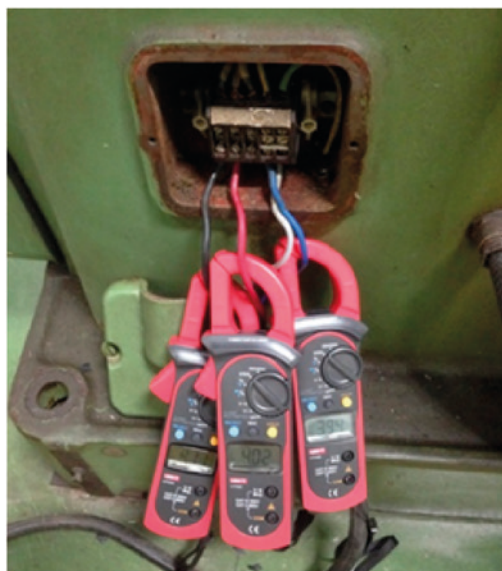
รูปที่ 5 การตรวจวัดกระแสในขณะทำการเชื่อม
