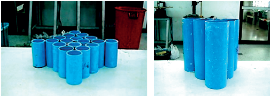
รูปที่ 9 แบบหล่อ \phi 3.5 ซม. สูง 7.1 ซม. (สำหรับการทดสอบ UC) และ \phi 8.75 ซม. สูง 25 ซม. (สำหรับการทดสอบ PRP)
