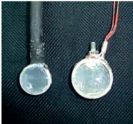
รูปที่ 6 หัวกดแบบ PRP ทั้ง 2 ขนาด คือ \phi 16.35 มม. หนา 5.67 มม. และ \phi 22.20 มม. หนา 6.10 มม.
