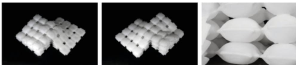
รูปที่ 24 งานวิจัยรวมของ BMW-MIT ที่แสดงชิ้นงานที่พิมพ์ที่ออกแบบครั้งแรกด้วยการพิมพ์ 3 มิติที่สามารถเปลี่ยนรูปร่างให้พอง-ยุบได้ (printed inflatable material) ได้หลังจากเสร็จสิ้นกระบวนการพิมพ์ [74]
