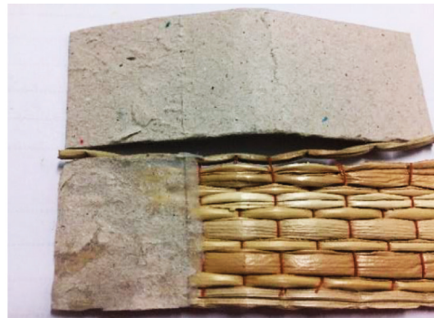
รูปที่ 8 ลักษณะการแตกหักของชั้นทดสอบเมื่อทดสอบแรงยึดติดแบบการลอกแบบตัวที่ (T-Peel)
