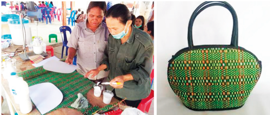
รูปที่ 11 การทดลองใช้กาวน้ำยางธรรมชาติและผลิตภัณฑ์กระเป๋าสื่อเตยหนามที่ใช้กาวน้ำยางธรรมชาติ
