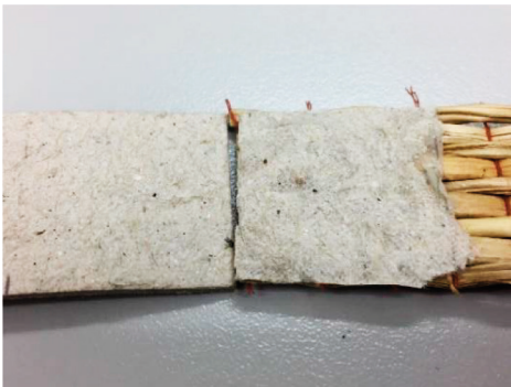
รูปที่ 8 ลักษณะการแตกหักของชั้นทดสอบเมื่อทดสอบแรงยึดติดแบบการลอกแบบตัวที่ (T-Peel)
