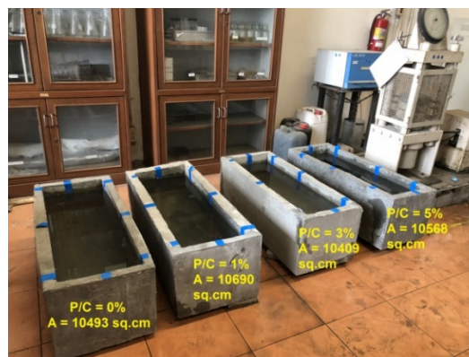
รูปที่ 11 ทดสอบการรั่วซึมน้ำ
