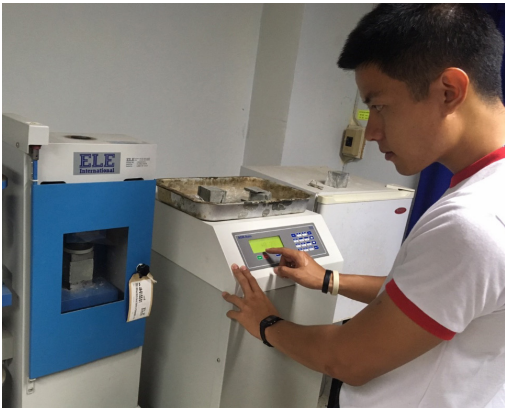
รูปที่ 3 การทดสอบกำลังรับแรงอัดมอร์ตาร์
