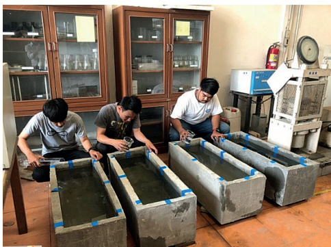
รูปที่ 6 การวัดการรั่วซึมของน้ำในคูล่งน้ำ
