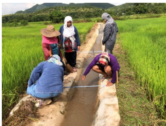
รูปที่ 20 วัดขนาดหน้าตัดคูส่งน้ำ
