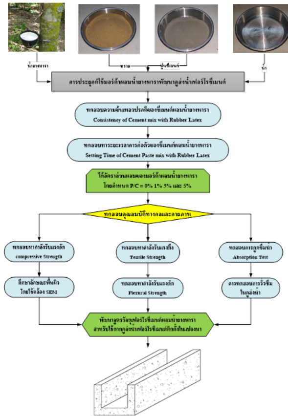
รูปที่ 1 ขั้นตอนการทดสอบสมบัติทางกายภาพและทางกลของวัสดุเพอร์โรซีเมนต์
