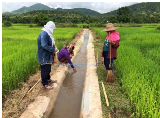
รูปที่ 19 วัดความเร็วและห้อตราการไหลของน้ำ
