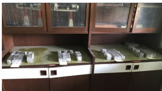
รูปที่ 2 การบ่มตัวอย่างชิ้นงานทดสอบ
