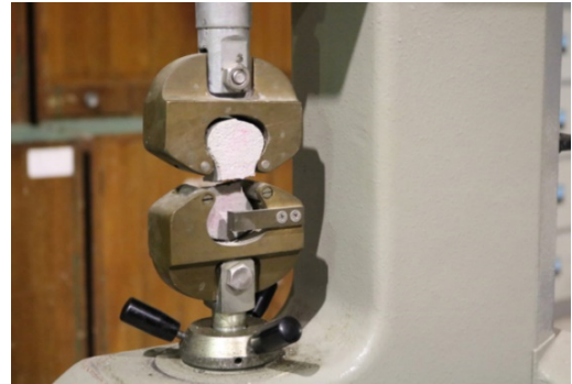
รูปที่ 4 การทดสอบกำลังรับแรงดึงมอร์ตาร์
