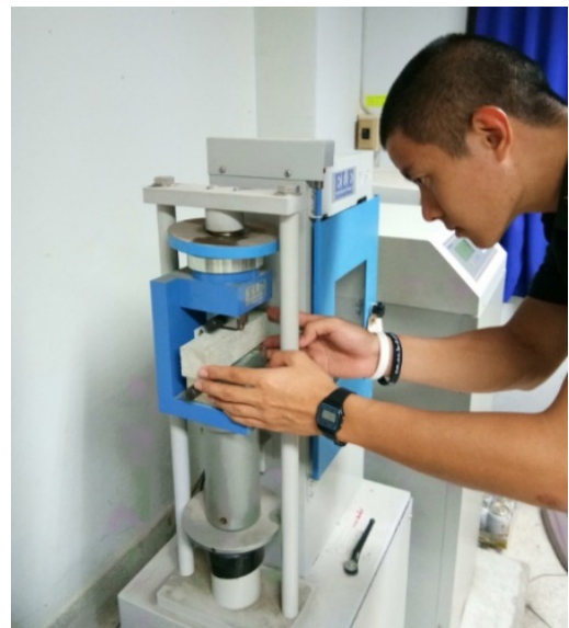
รูปที่ 5 การทดสอบกำลังรับแรงดึง
