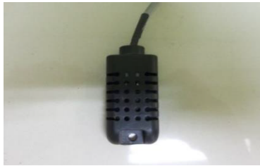
ง) ติดตั้งเซ็นเซอร์วัดอุณหภูมิและความชื้น
