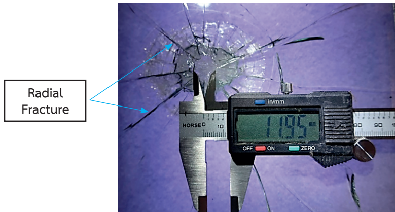
รูปที่ 6 การวัดขนาดของรูกระสุนปืน
